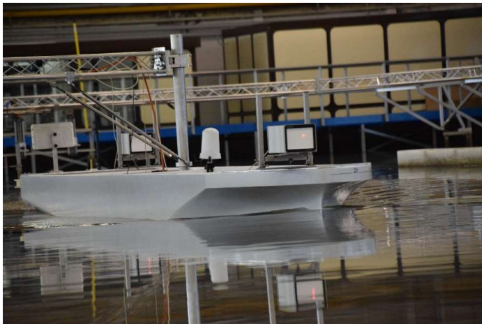
Modellschiff im maßstäblichen physikalischen Versuch im Schiffswellenbecken
