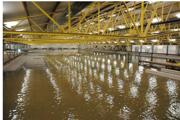
Physikalisches Modell - Abschnitt Rechtenfleth (v.l.: trocken, mit Wasser gefüllt, mit Schiffsbetrieb)
