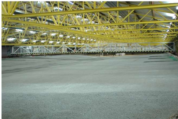
Physikalisches Modell - Abschnitt Rechtenfleth (v.l.: trocken, mit Wasser gefüllt, mit Schiffsbetrieb)
